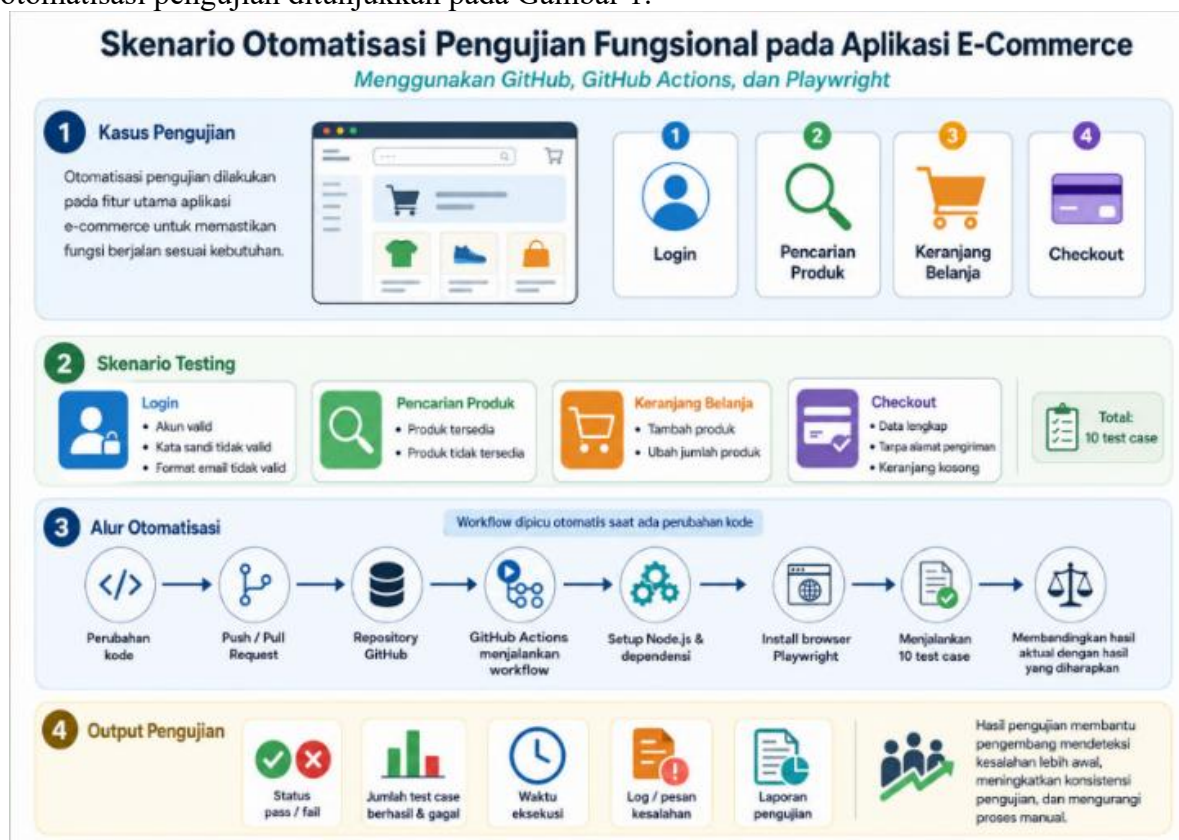
Gambar 1. Skenario Otomatisasi Pengujian Fungsional pada Aplikasi E-Commerce
